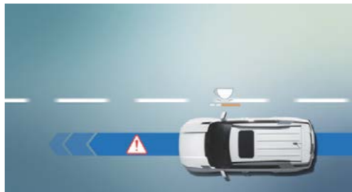
DAA (התראת עירנות נהג) אם מערכת ה-DAA מזהה שרמת עירנות הנהג נמוכה באופן משמעותי, היא תשמיע אזהרה קולית ותציג גרפיקה על גבי אגד המכשירים.
