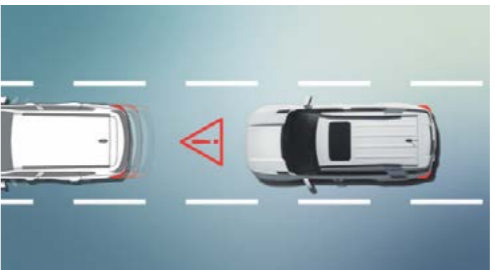
FVSA (התראת רכב מתקדם) המערכת מושכת את תשומת לב הנהג בעזרת התראה קולית וויזואלית כשהרכב שנמצא לפניו מתחיל להתקדם.
