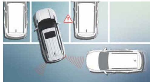
RCTW (סיוע במניעת התנגשות עם רכבים שחוצים מאחור) בעת זיהוי רכב מתקרב בסניעה לאחור, המערכת תשמיע אזהרה קולית כדי למזער את הסיכון לתאונה.
